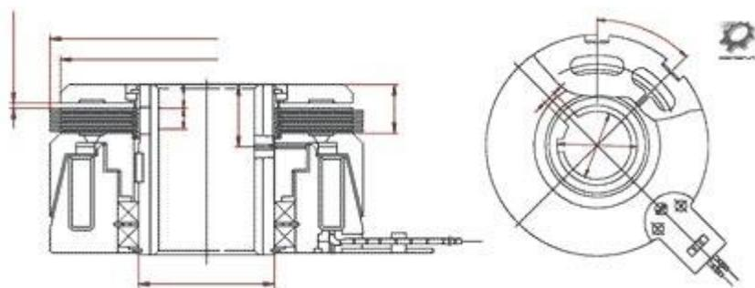
Габаритные и присоединительные размеры электромуфт бесконтактного исполнения на подшипниках Э1ТМ...4П:
