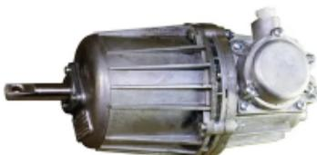
Электрогидравлические толкатели ТЭ предназначены для применения в качестве привода колодочных пружинных тормозов, подъемно-транспортных машин, а так же для привода механизмов автоматики.
